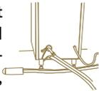
2. Schlauch am Anschlussstutzen, je nach Modell hinter oder unter der Maschine, anschrauben ohne zu fest anzuziehen.
